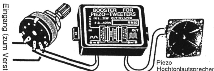
Mit einem Potentiometer 500 Ohm linear kann die Ausgangsleistung des Moduls reduziert werden.
